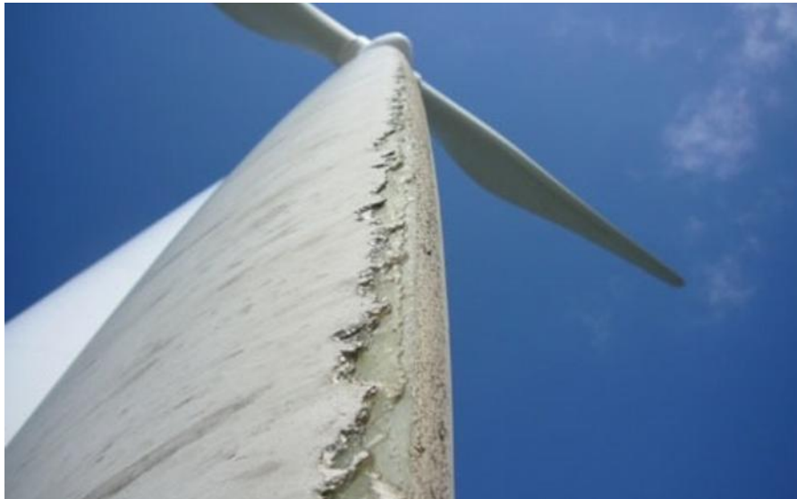
Slitasje på turbinvinge (Kilde: https://www.froya.no/nyheter/forurensing-vindm%C3%B8ller )
